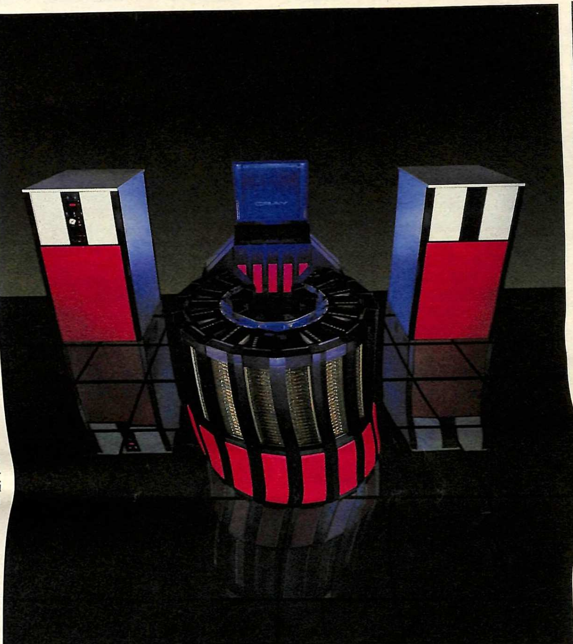
Le Cray II : il dégage tellement d'énergie lors de son fonctionnement que sans le système de refroidissement, il prendrait feu
